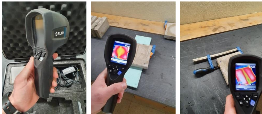
Figura 3.26 Representação da utilização da câmara termográfica.
