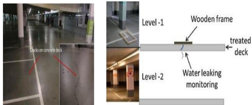
Figura 2.17 Caso de estudo do parque de estacionamento e ensaio de permeabilidade in-situ (Wiktor e Jonkers, 2015).
