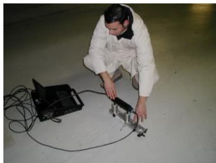
Figura 2.5 Medição da profundidade de fissuras em uma laje de betão (Oz Diagnóstico.pt).
