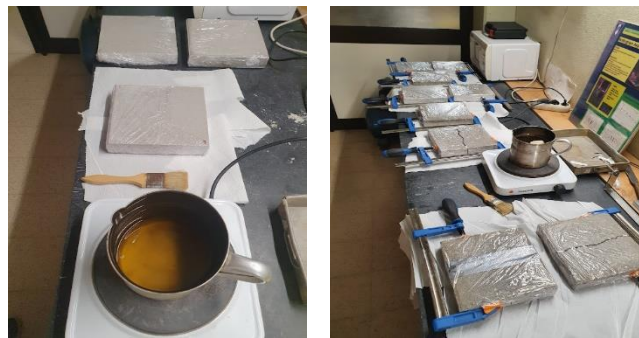
Figura 3.11 Passagem de parafina sobre as amostras com película impermeabilizante.
