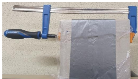
Figura 3.12 Amostra após aplicação de fita-cola de alta resistência sobre a região fissurada.
