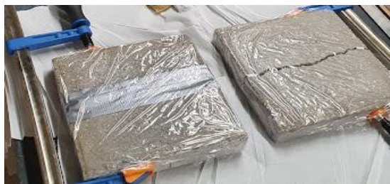
Figura 3.10 Aplicação de película plástica impermeabilizante nas amostras como fase de preparação para o tratamento (à esquerda a fissura tem 10 mm e está preenchida com areia; à direita a fissura tem 1 mm e não tem qualquer preenchimento).
