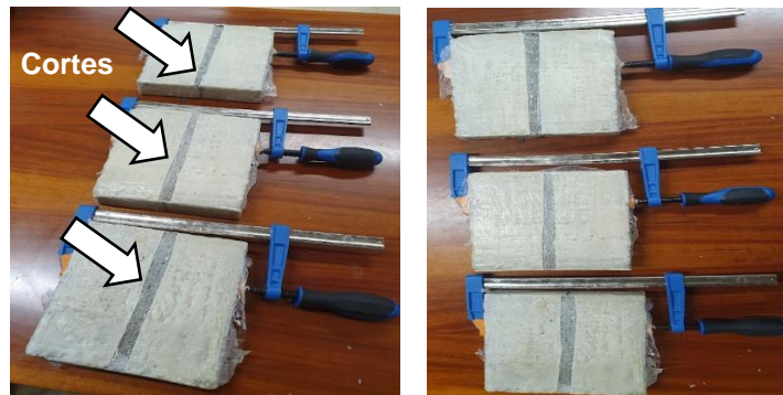
Figura 3.19 Abertura da parafina coincidente com a região da fissura para realização de testes com coluna de água.
