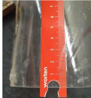
Figura 3.22 Posicionamento da fita métrica na coluna utilizada nos ensaios de estanqueidade.
