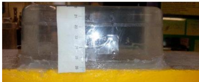
Figura 2.16 Aplicação do fluido de tratamento com o auxílio de um reservatório plástico (Cardoso et al. , 2018).
