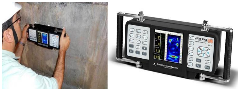
Figura 2.6 Equipamento de tomografia para inspeção de betão (Ultra Lab Engenharia Diagnóstica, 2022).
