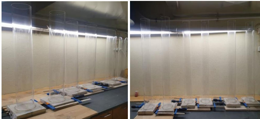
Figura 3.20 Colunas de acrílico posicionadas e fixadas com silicone nas respetivas amostras.
