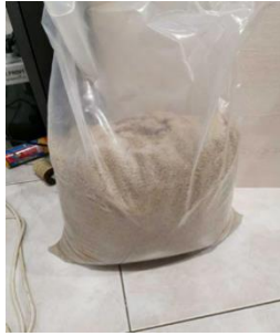
Figura 3.1 Areia APAS30 usada para enchimento das fissuras com 10 mm ( D_{50} = 0,250 mm, G_s = 2,66 ).
