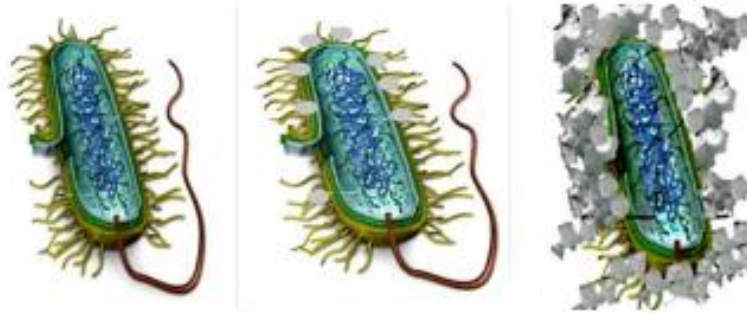
Figura 2.14 Bactéria ao longo do processo de biocimentação, com o início da reacção (à esquerda), aparecimento do precipitado (ao centro) e em fase de latência (à direita) (Verstraete et al. , 2008).
