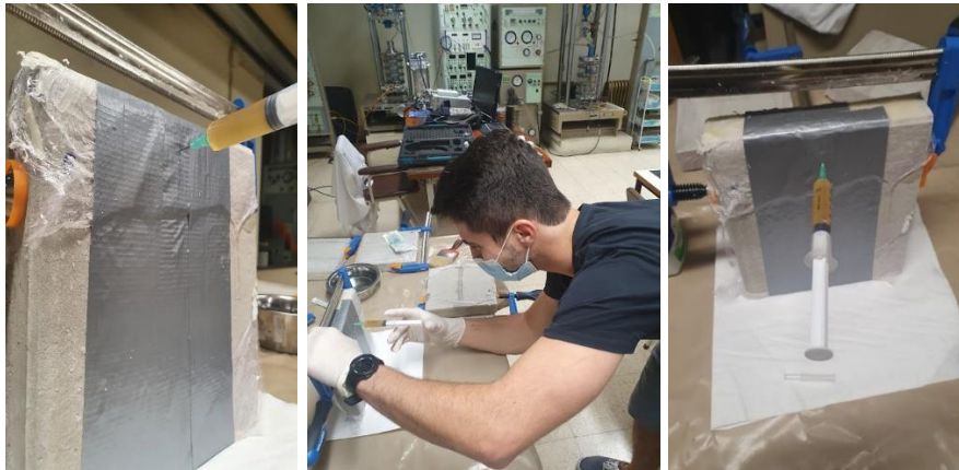
Figura 3.14 Detalhe do aparato para inoculação das soluções de alimento e bactéria nas fissuras tratadas.
